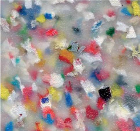
*Origins, materiale realizzato con polietilene riciclato proveniente da bottiglie colorate di detersivo, fasciolate a seconda del colore, tagliuzzate e lavate. Dopo la fusione dei fiocchi il materiale viene compresso per ottenere il prodotto finale in fogli. Questa tecnica consente di mantenere inalterate le sue caratteristiche estetiche altrimenti non ottenibili con lo stampaggio a iniezione o con l'estrusione, lavorazioni che omogeneizzerebbero il colore. Produzione Yemm & Hart, USA.*
