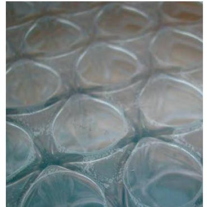
*Birdwing Panel, pannello alveolare con cellule a forma conica realizzabile in policarbonato, PET, ABS, polistirene. Produzione Bencore, Italia (foto copyright Innovathèque).*
