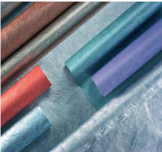
*Tyvek, materiale derivato da microfibre di polietilene ad alta densità, associa proprietà della carta, di film e di tessuti. Permeabile al vapore, resistente all'acqua, alle sostanze chimiche, alle lacerazioni, alle perforazioni e alle abrasioni. Produzione DuPont (foto gentilmente fornita da DuPont).*
