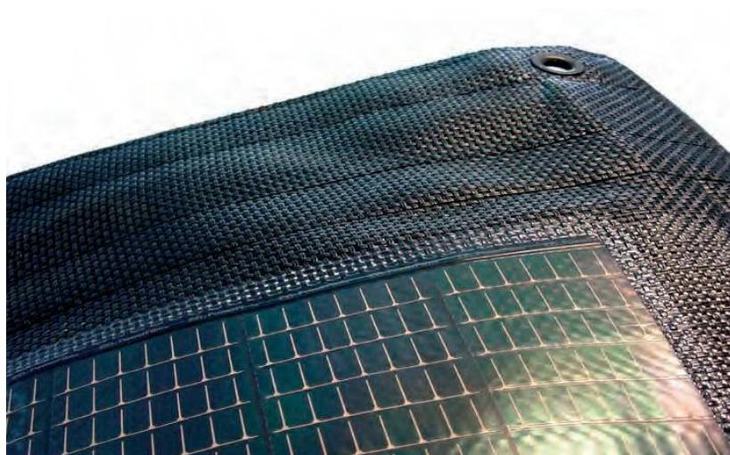
*PowerFilm, film fotovoltaico flessibile arrotolabile che assorbe energia solare e produce elettricità. Il procedimento produttivo adottato, denominato roll-to-roll, consente di integrare monoliticamente le sottili cellule di silicio in un substrato polimerico che le preserva dall'invecchiamento e da eventuali danneggiamenti. Produzione Iowa Thin Film, USA.*
