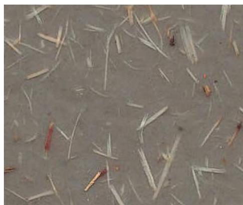
*Fiber, laminato ad alta pressione Print HPL, nella superficie sono inclusi frammenti di fibre vegetali che si compongono in modo casuale. Produzione Abet Laminati, Italia.*
