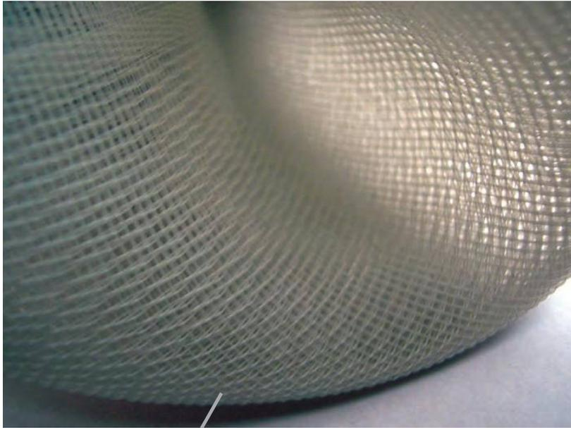
*Tri X, geotessile tridimensionale in poliamide per filtraggio. Produzione Rai- Tillieres, Francia (foto copyright Innovathèque).*
