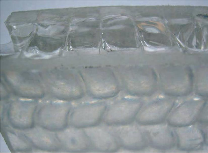
*Pannello alveolare in polietilene o policarbonato. Produzione Panelite, USA (foto copyright Innovathèque).*
