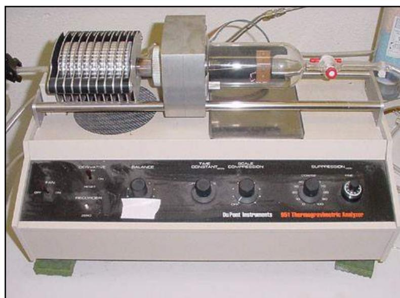
**Figura 3.18** – TGA Modello 951 *Du Pont*.
